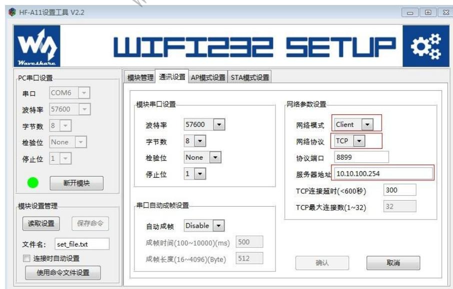
注意:AP 端为服务器端, 所以 STA 端要选择客户端。他的服务器 Ip 为 AP 端的 IP。
