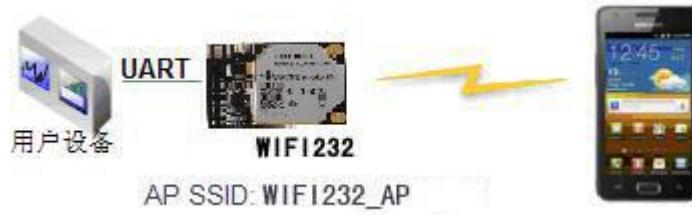
如上图，WIFI232-A/B 模块作为 AP，串口连接用户设备，智能手机等设备可以支持连接到 WIFI232-A/B 模块上。通过无线网络控制用户设备。
