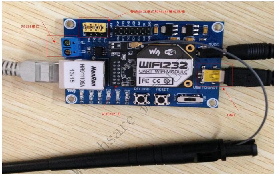
当使用串口模式通信的时候黄色的跳线帽连接串口模式；如果使用 485 模式。跳线帽连接到 485 模式，跳线帽将连接下一排跳线帽。
