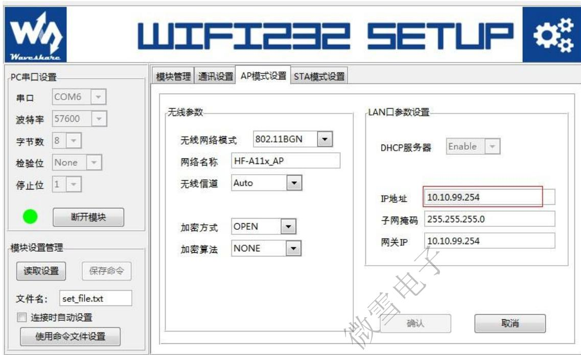
注意: 这个 LAN 口参数的 IP 要和服务器 AP 端的 IP 在同一个网段。
