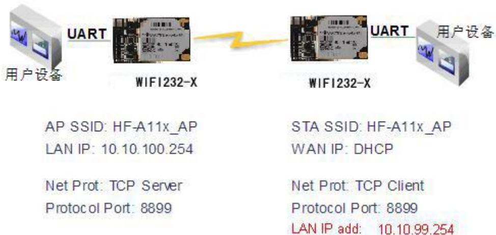
如图，左边 WIFI232-A/B 模块设置为 AP 模式，SSID 及 IP 地址默认，网络协议设置成 TCP/Server 模式，协议端口默认为 8899；右边 WIFI232-A/B 模块设置为 STA 模式，SSID 设为要连接的 AP 的 SSID (HF-A11\_AP)，默认为 DHCP，网络协议设置成 TCP/Client 模式，协议端口 8899，对端 IP 地址设成左边模块的地址，即 10.10.100.254。当右边模块启动后会找 AP (SSID: HF-A11\_AP)，然后自动起 TCP client 端并连接左边模块的 TCP Server。所有连接自动完成，然后两边的 UART 就可以透明传输数据。
