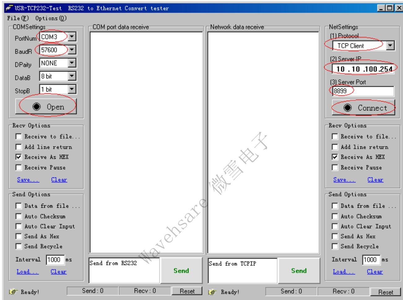
至此, 你就可以在串口和网络之间进行数据收发测试了, 串口到网络的数据流向是: 计算机串口->模块串口->模块 WIFI->计算机网络, 网络到串口的数据流向是: 计算机网络->模块 WIFI->模块串口->计算机串口。
