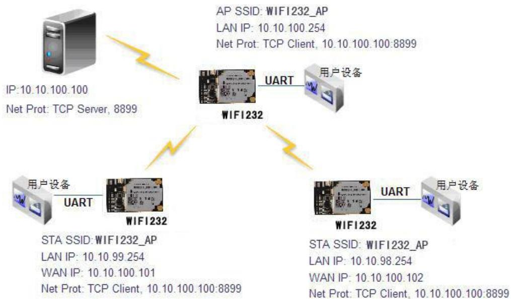
图中每个 WiFi232-A/B 模块通过 UART 连接用户设备作为数据采集卡，其中一个作为 AP，其它的为 STA，一台 PC 作为数据采集服务器。作为 STA 的 WiFi232-A/B 模块和 PC 都通过无线网络连接到作为 AP 的 WiFi232-A/B 模块上，组成一个无线网络。
